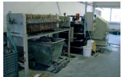
**Zentrifuge mit Filtrationssystem, um das Wasser von Schleifmitteln und Aluminiumabrieb zu trennen und damit den Wasserverbrauch auf ein Minimum zu reduzieren.**
