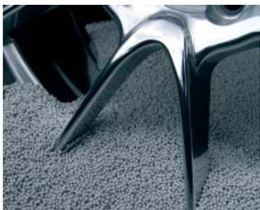
glänzt in einzigartiger Art und Weise, absolut unvergleichbar mit einem handpolierten Rad. Beim Verdichten wird die Oberfläche komprimiert
