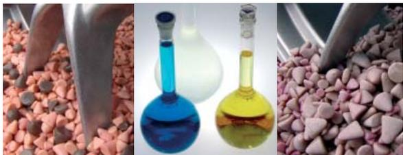
Die Felge wird mit gesteuerten Bewegungen in einem Schleifkörpergemisch geschliffen und mit chemischen Mitteln mechanisch poliert.
