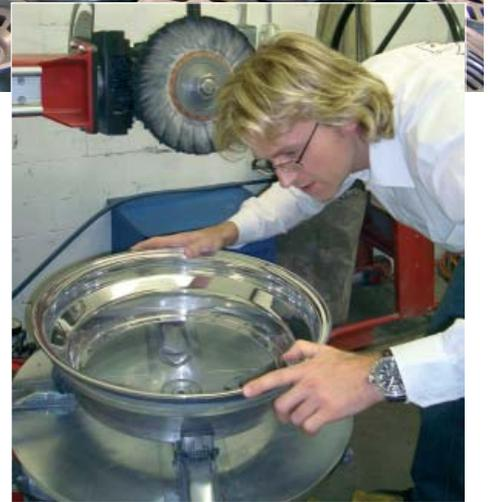
**Qualitätsprüfung: mechanisches Spiegelpolieren am Felgenring-Polierautomaten.**
