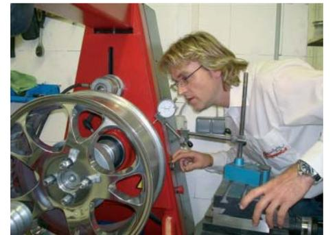
**Neue Richtanlage zur Rundlaufinstandsetzung von Alufelgen bis 26 Zoll.**
