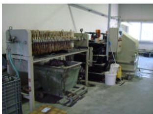
Bild: Abwasserreinigung u.Pressanlage
